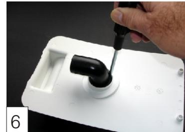
6 Gummidichtung in Aufnahme einsetzen 90° Winkel einsetzen Gummidichtung mit Schraubendreher nach oben schieben. Dichtung muss mit oberem Gehäuserand (1) gleichmäßig abschließen. 90° Winkel waagrecht gegen Abdeckplatte ausrichten.
