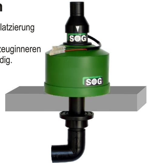
Montagebeispiel: Vor dem Einsetzen des Lüfters in die Filterpatrone muss der Aufnahmegummi mit etwas Wasser angefeuchtet werden. Die Filterpatrone, integriert mit dem Lüfter, muss nicht in der Nähe des WCs montiert werden.
