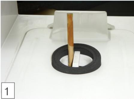
1 Durch die Bohrung der Abdeckplatte mit Bleistift Bohrloch übertragen.
