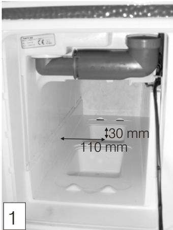
1 Zu bohrendes Loch an der Rückwand des Faches nach Bildangabe anzeichnen.
