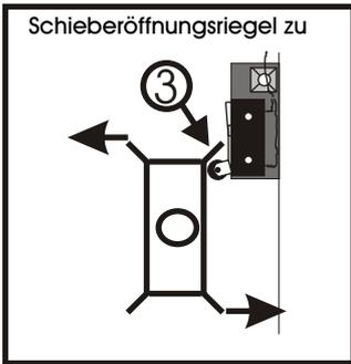
**Der Aluminiumwinkel muss so eingeklebt werden, dass die Gleitrolle 3 des Microschalters genau vor der Schräge des Schieberöffnungsriegels anliegt.**
