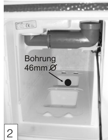
2 Mit einem 46 mm Topfbohrer die Rückwand aufbohren
