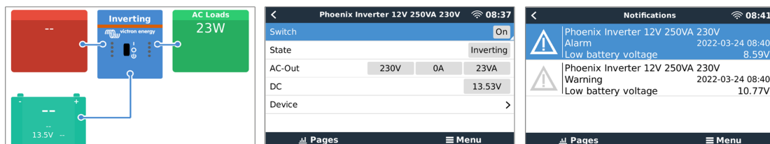
Przykładowe ekrany GX od lewej do prawej: ekran systemu, ekran urządzenia falownika i komunikat alarmu.
